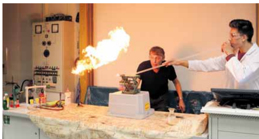
„Staubexplosion“ mit Bärlapp-Sporen und Blasrohr.
