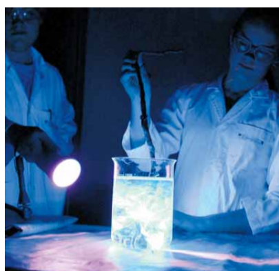
Äskulin, ein Glykosid, fluoresziert blau. Ultraviolettes Licht macht die austretenden Schlieren sichtbar.
