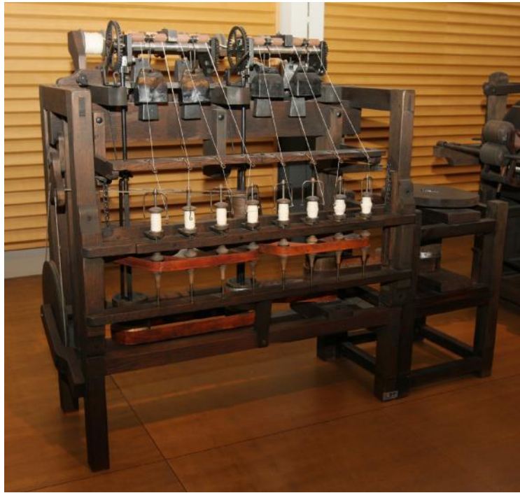
Figura 1.10 – Il filatoio idraulico water-frame. inventato nel 1769 da Richard Arkwright.
